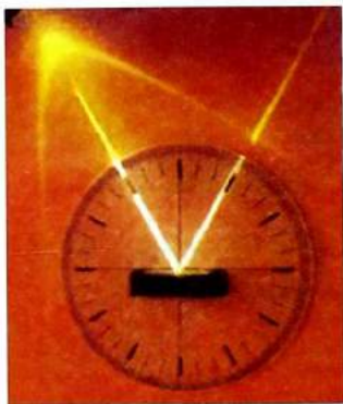
73-сүрөт. Жарыктын чагылуусун үйрөнүүгө арналган түзүлүш.
